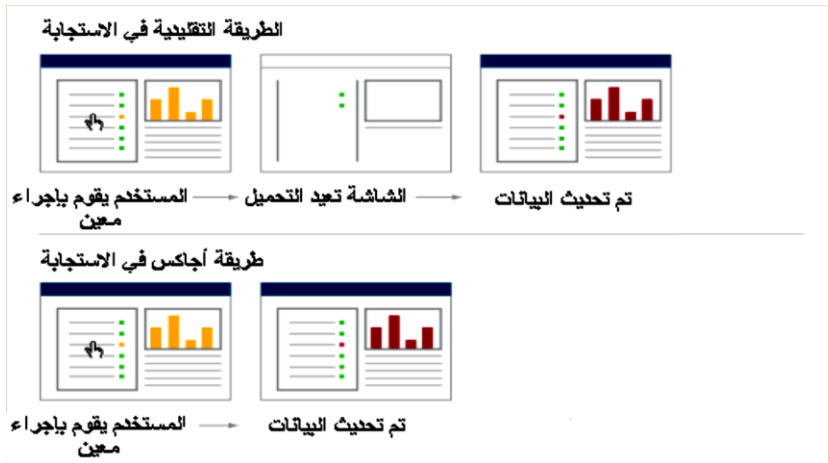
شكل (٣) الفرق بين الطريقة التقليدية في الاستجابة لطلب المستخدم في المواقع العادية (أ) وطريقة أجاكس (ب)
